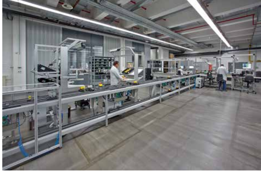
Ein beliebig erweiterbares Werkstückträger-Umlaufsystem erlaubt die flexible Kopplung sämtlicher möglichen Fertigungsressourcen zu einem Produktionssystem. I/O-Module mit hoher Varianz können auf dem flexiblen Produktionssystem wirtschaftlich hergestellt werden.
